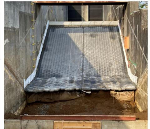
写真-3 越水実験後状況
