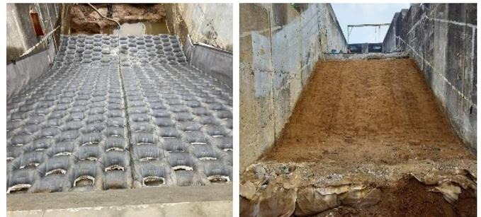
図-7 実験後被覆工の状況
