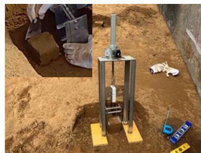
写真-13 引張破壊応力試験状況
