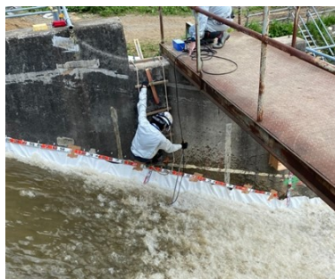
写真-11 流速計測状況
