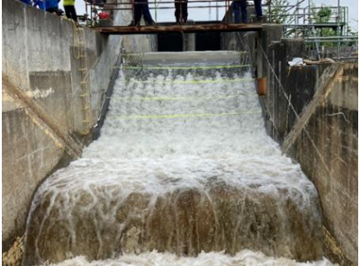
図-7 越水実験状況（試験中）
