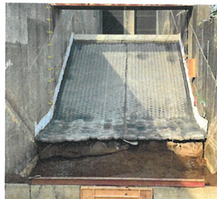
写真-3 越水実験後状況
